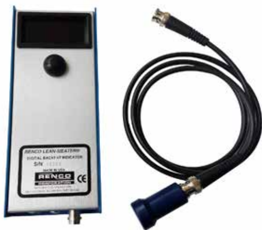
美国 Renco B-07 背标诊断仪用脉冲超声波来测量哺乳动物三层背膘厚度
